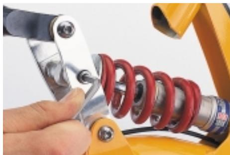
▶ **2** Auf's Wetter kommt's an: Zwischen 120 Stunden bei Trockenheit und 80 bei überwiegend nassen Bedingungen liegt die Länge des SERVICE-INTERVALLS. Wer dies beherzigt, reduziert den Verschleiß auf ein Minimum. Besonders verschleißanfällig sind die beigefarbenen Polymerlagerbuchsen, die bei sichtbarem Abrieb oder bei Spiel in einem Gelenk ausgetauscht werden müssen. Die metallischen Gelenkachsen müssen Sie
