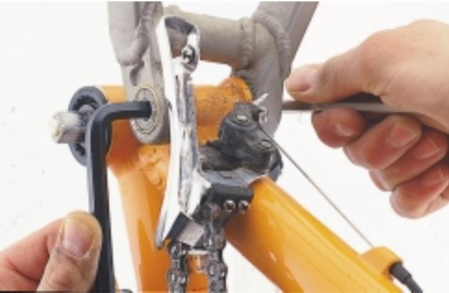
► 5 Zerlegen Sie schließlich das SCHWINGEN-HAUPTLAGER. Dazu ist die Demontage der rechten Kurbel oder der Kettenblätter unabdingbar. Lösen Sie die Schraube auf der Nichtantriebsseite (links), und halten
