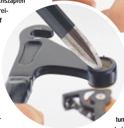
► 8 Perfektionisten legen die sauberen oder neuen Buchsen über Nacht in eine verschlossene Schüssel mit KryTech ein. Sie können diese aber auch schmieren und vor dem ZUSAMMENBAU trocknen lassen, nachdem Sie die Gleitbuchsen in ihre Lagersitze gedrückt haben. Geht das nicht von Hand, entgraten Sie den Lagersitz vorsichtig mit einem Schaber. Achtung: Die Buchsen für das Hauptlager sind verschieden lang. Die kürzere von beiden (14 und 16,4 mm) gehört auf die Antriebsseite.
