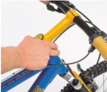
**1** Erster Schritt: die **PRÜFUNG** des Lager-spiels. Vorderradbremse blockieren und das Bike vor- und zurückschieben. Dabei mit der freien Hand an die obere Lagereinheit greifen. Bei Spiel zwischen oberer und unterer Lagerschale muß das Lager neu eingestellt werden.
