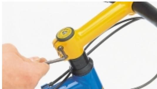
**2** Das Bike auf den Boden stellen und die **VORBAU**klemmung lösen. Wenn zwei Klemmschrauben vorhanden sind, diese möglichst gleichzeitig, nicht nacheinander lösen, indem man jeweils nach einer viertel Umdrehung die Schraube wechselt. So wird die Überlastung einer einzelnen Schraube verhindert.
