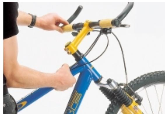
Bei älteren Bikes mit **5 GEWINDE** am Gabelschaft statt Aheadset-Lagertechnik erfolgt die Prüfung des Steuerkopflager-spiels wie in Schritt 1. Nun aber wird mittels Innensechskant die Vorbau-klemmung gelöst und dieser aus dem Gabelschaftröhr herausgezogen.
