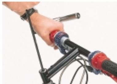
**4** Vor der **ENDPRÜFUNG** den Vorbau wieder befestigen (dabei unbedingt das vorgeschriebene Anzugsmoment beachten, am besten vom Profi-Mechaniker zeigen lassen). Die erste Prüfung erfolgt wieder wie in Schritt 1. Dann das Vorderrad vom Boden abheben. Dreht sich der Lenker nach leichtem Antippen aus der Mittellage nach links oder rechts, ist die Lagereinstellung perfekt. Wird seine Bewegung abgebremst (nicht von den Seilzügen), zurück zu Schritt 3 und Lager etwas lösen.
