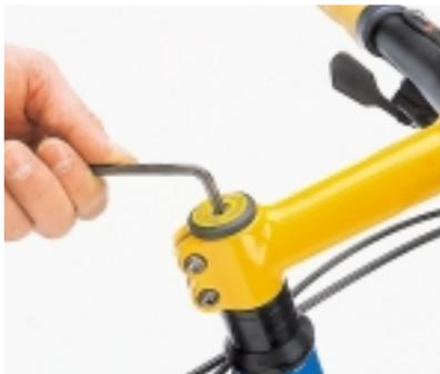
**3** Nun das **STEUERKOPF-SPIEL** justieren. Bei Lager-spiel (oder -knacken) die Einstellschraube in der Vorbau-Abdeckkappe anziehen. Bei zu strammem Lager (erkennbar an leichtem Widerstand beim Drehen des Lenkers) muß sie geöffnet werden. Nie mehr als eine viertel Umdrehung verändern, ohne eine weitere Prüfung vorzunehmen.
