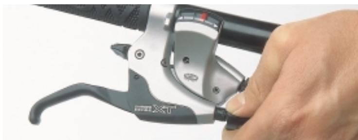
**5** Mit der Hohlsschraube an der Bremshebelarmatur wird über die Außenhülle des Bremszuges der **HEBELWEG** bestimmt. Beim Einbau eines neuen Zuges immer die Einstellschraube bis auf eineinhalb Umdrehungen ganz in die Armatur einschrauben. So läßt sich nach der Montage des Zuges am V-Brake-Arm der Hebelweg individuell größer oder kleiner justieren. Tip: Verschlissenen Bremszug und Außenhülle nie einzeln, sondern immer gemeinsam wechseln!
