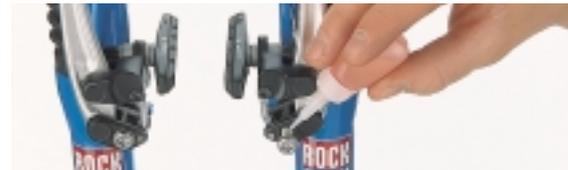
**2** Die Sockelschrauben, welche die V-Brake-Arme fixieren, mit einem Topfen **SCHRAUBENSICHERUNG** in die Sockel drehen. Mit dem Inbusschlüssel festziehen, nicht überdrehen, da sonst die Gewinde ausreißen können.
