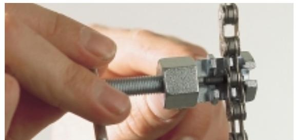
**3** Das **VERNIETEN** der Kette verläuft in umgekehrter Reihenfolge wie das Trennen. Um die Dauerhaltbarkeit der Nietstelle zu gewährleisten, sollte man bei Shimano-Ketten den speziellen Reparurniet verwenden. Für On-the-trail-Reparaturen kann man sich mit dem alten Nietstift behelfen, sollte ihn aber schnellstmöglich austauschen, da die Kette an dieser Stelle nun nur noch gesteckt und nicht mehr genietet ist.
