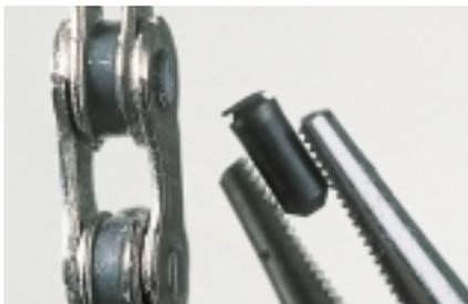
**4** Der **REPARATURSTIFT** bei Shimano-Ketten wird vollständig eingetrieben, bis man die Führungsspitze des Nietbolzens mit einer Zange abbrechen kann. Der Bolzen hat hier eine Sollbruchstelle, Sie können also gar nichts verkehrt machen.
