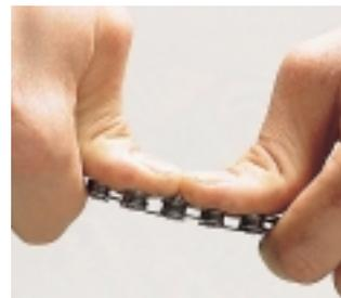
**5** Die frisch vernieteten Glieder können etwas steifer sein als der Rest der Kette. Um einen gleichmäßigen **KETTENLAUF** zu gewährleisten, biegen Sie die Nietstelle etwas hin- und her, dann läuft die Kette wieder wie neu.
