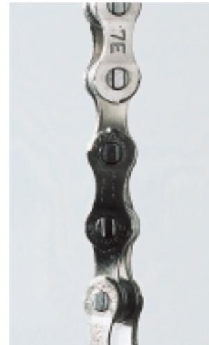
**1** So sieht eine **KETTE** nach dem berüchtigten Chain-Suck, dem Kettenklemmer zwischen Kettenblatt und Rahmenstrebe, aus. Selten übersteht der Gliederstrang diesen Würgegriff ohne bleibenden Schaden. Einzige Lösung des Problems: verdrehte Glieder entfernen. Mehr als einen Kettenniet brauchen Sie dazu nicht – wie es geht, erklären wir Ihnen hier.
