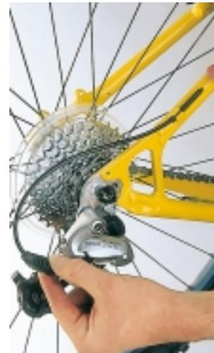
**2** Spätestens jetzt muß der Schaltzug angeklemt werden (vorher die Stellschrauben an Schaltwerk und -hebel bis auf eine Umdrehung hineindrehen!). Danach wird mit der Schaltwerkstellschraube der Zug leicht unter **SPANNUNG** gesetzt. Bei Sram-Komponenten – egal ob ESP oder Di.R.T. – fehlt diese. Hier die Zugspannung an der Einstellschraube des rechten Drehgriffs einstellen.
