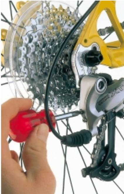
**1** Zunächst kommt die Kette vorne aufs große Kettenblatt, hinten aufs große Kettenritzel. Dann wird der **ÄUSSERE ANSCHLAG** festgelegt: oberes Leitrollchen exakt unter das kleinste Ritzel positionieren – bei Shimano dient dazu die obere, bei ESP die untere und bei Di.R.T.-Schaltwerken die vordere Anschlagsschraube. Diese Arbeit kann auch vor der Montage von Kette und Schaltzug erfolgen.
